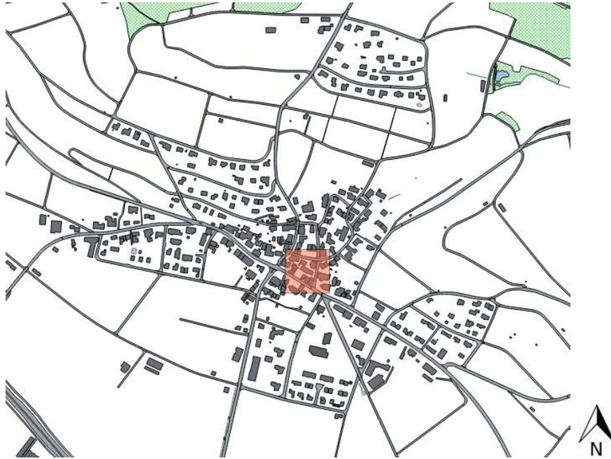
Abbildung 12: Potenzialgebiet für einen Wärmeverbund. Die Baudichte ist im ha-Raster angezeigt. Ab einer Baudichte von 20'000 m<sup>3</sup>/ha ist ein Wärmeverbund für unsanierte Altbauten geeignet (dunkelrosa Quadrat).
