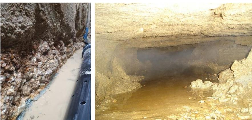
**Grundwasser** ist Wasser, welches in einem grossen unterirdischen See vorhanden ist, der komplett mit Kies durchsetzt ist. Durch das Graben eines tiefen Schachts erreicht man die wasserführende Schicht im Kies. Gespiesen wird dieser See mit Wasser aus dem Grundwasserstrom des Rheins. Mittels Pumpen wird das Wasser an die Oberfläche und in das Reservoir transportiert.
