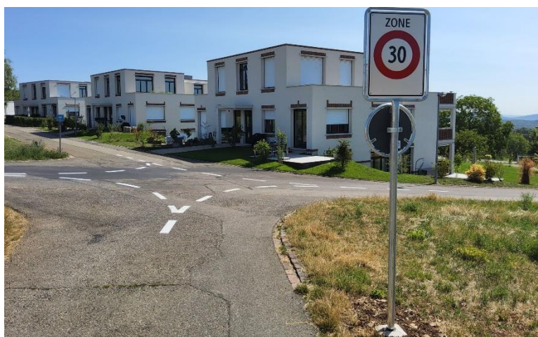
Abbildung 13: Beispiel Zoneneingang am Fahrbahnrand
