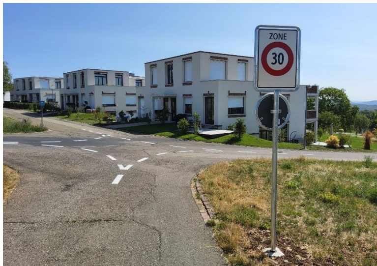
Abbildung 7: Beispiel Zoneneingang am Fahrbahnrand
